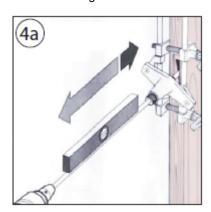
Den Bohrer mit Wasserwaage waagerecht ausrichten.
