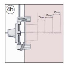
Ausführung der Bohrung fürs Kabel stets nach 75 mm Bohrtiefe unterbrechen, den Bohrer herausziehen, um Späne zu entfernen.
