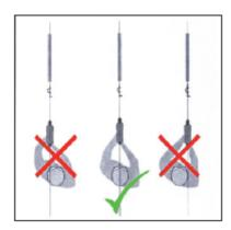
**ACHTUNG:** Stets in der Achse des Bohrers stehen, um auf den Bohrer keinen Seitendruck auszuüben, damit er nicht gebrochen wird.
