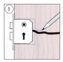
Nach dem Fräsen der Schlosstasche und Stirnfräsung. Schloss außen an der Tür halten und Stelle markieren, an der das Kabel austritt
