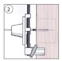
Den Langbohrer in die Vorrichtung einführen und nach der Stift-Markierung ausrichten. Das untere Klemmenpaar festziehen.
