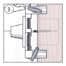
Das obere Klemmenpaar nach untern bewegen, bis es aufsitzt. Festziehen. Nun ist die Vorrichtung fixiert und gegen Bewegung auf Schienen nach oben und unter gesichert.
