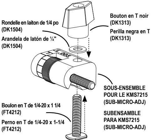
**2** Insérez la tête du boulon en T de 1/4 po x 1 1/4 po dans la fente en T de la traverse de fixation du guide et glissez le micro-ajusteur vers le bloc de serrage.
