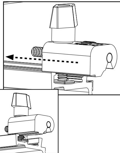
**3** Alignez la vis filetée du micro-ajusteur avec le trou pour l'accessoire du bloc de serrage. Insérez la vis pour micro-ajusteur dans le bloc de serrage en tournant la molette de réglage du micro-ajusteur jusqu'à ce que la vis soit insérée dans le bloc de serrage environ aux trois quarts.
