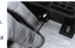
Přívod vzduchu musí být mezi 550 - 700 kPa (cca 80psi - 100psi). Vyšší tlak jak 800kPa (120psi) může poškodit přísavku a být pro obsluhu nebezpečný. Nižší tlak snižuje účinnost přísavky. Toho lze využít při upevňování molitanu.
