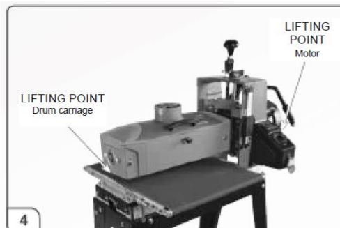
LIFTING POINT Drum carriage - HEBEPUNKT Zylinderunterstützung LIFTING POINT Motor - HEBEPUNKT Motor
