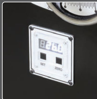
A körfűrészlap dőlésszögének digitális kijelzője
