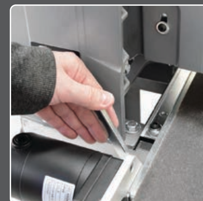
Kar az asztal emeléséhez széles munkadarabok csiszolásához
