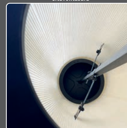
A szűrő tisztítása szétzerelés nélkül
