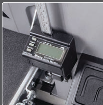
Digitális kijelző - munkadarab vastagsága
