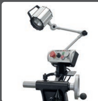
Második teljes értékű vezérlő panel, két helyre is felzerelhető
