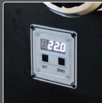
A körfűrészlap dőlésszögének digitális kijelzője
