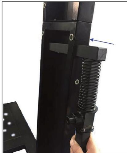
Étape n° 13 : assurez-vous que la pédale est du bon côté et insérez-la dans l'orifice du panneau de support vertical inférieur. Prenez le support inférieur et utilisez des boulons hexagonaux (2) de 5/16" x 1-3/4", des rondelles plates (4) de 5/16" et des écrous à six pans (2) de 5/16" pour fixer l'extrémité inférieure de la pédale sur la face intérieure de la plaque de support triangulaire. Procédez de la même manière pour le côté opposé.
