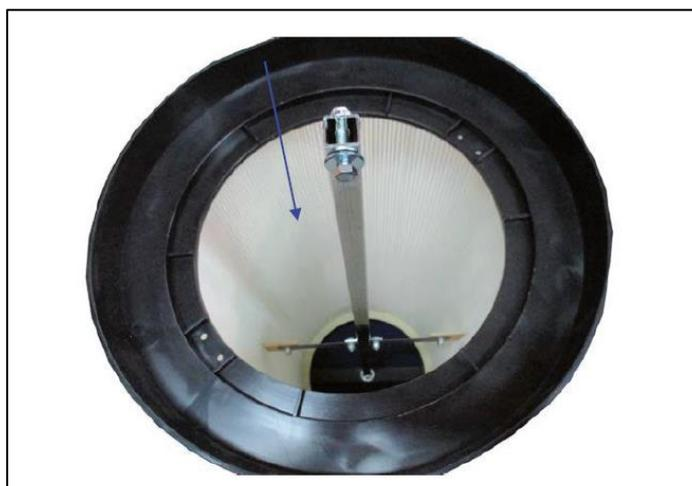
Étape n° 38 : fixez le filtre à la pièce centrale de séparation. Serrez la courroie de serrage et fixez-la avec le fermoir. Vérifiez que le filtre est correctement monté sur la pièce centrale de séparation et resserrez si nécessaire.
