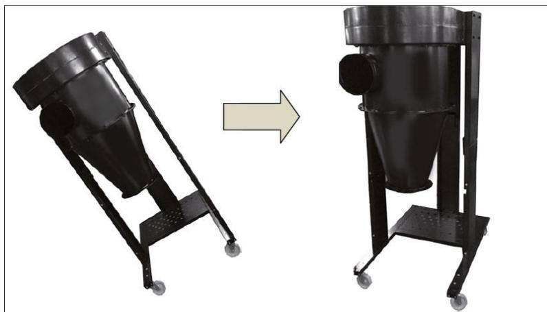
Étape n° 9 : fixez la plaque de support triangulaire inférieure à la base avec des vis à tête hexagonale (2) de 5/16 " x 3/4 " et des rondelles plates (2) de 5/16 " x 18 x 2. Procédez de la même manière pour le côté opposé.
