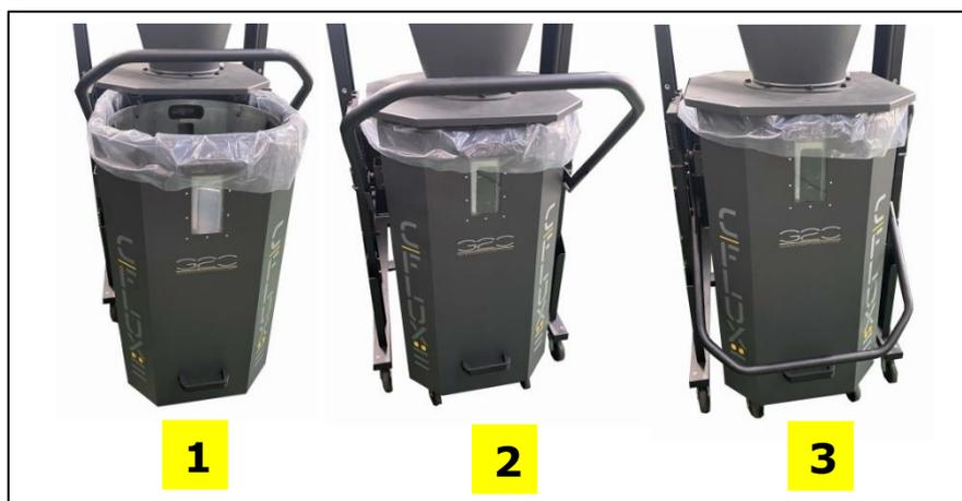
Étape n° 32 : au moment de placer le bac, assurez-vous que les côtés gauche et droit du bac sont bien en place dans le mécanisme de levage avant de le soulever vers la machine. Si le bac de collecte n'est pas correctement placé dans le mécanisme, il ne pourra pas être relié à la machine de façon étanche, ce qui aurait un impact négatif sur l'aspiration elle-même.
