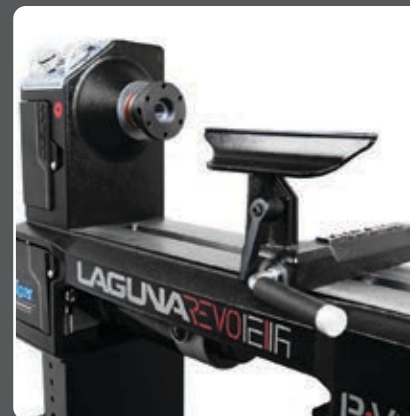
Masivní lože soustruhu široké 160 mm
