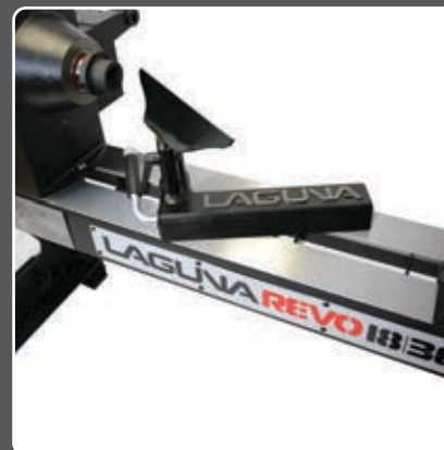
Masivní lože soustruhu široké 208 mm
